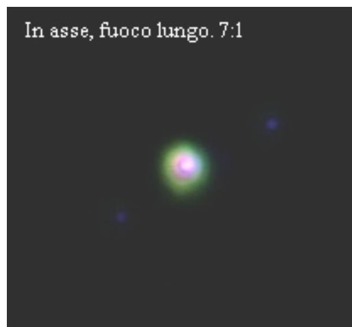
Fig. 3288/89/90 – La foto nel miglior fuoco, al centro del campo, mostra una centrica regolare. È visibile uno solo degli anelli poiché siamo in presenza di un sistema ad immersione. È normale.
