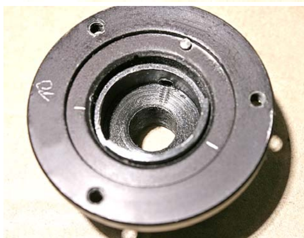
Figg. 3278/79/80/81 – Queste le fasi della lavorazione. Si noti che, prima di eseguire il foro, il pezzo 11? deve essere ruotato fino ad affiorare appena dall'orlo del pezzo 15 (fig. 3278). L'anello 10 può essere forato anch'esso, ma non ha più alcuna funzione.
