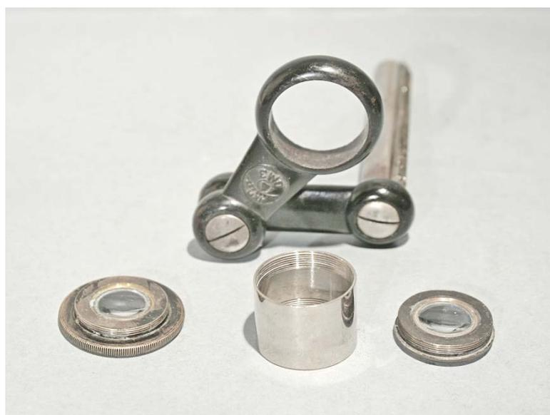
Una simile ricetta, a due lenti biconvesse, è molto insolita. In passato sono stati usati sistemi (oculari da microscopio) con due lenti biconvesse accostate (figura seguente), ma questo non è un valido precedente.
