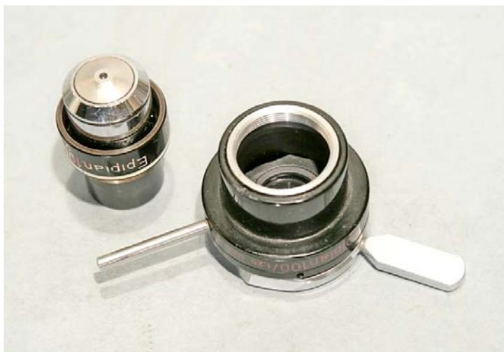
Fig. 2747/48 – Non è difficile svitare l'obiettivo (7) dal raccordo 6. In 8 è indicato il filetto a passo inglese (RMS) dell'obiettivo. Tale filetto è ribassato rispetto al sistema ottico poiché si doveva compensare l'altezza del raccordo (24 mm) per raggiungere una lunghezza ottica complessiva dell'obiettivo ( $L_o$ ) pari a 45 mm (norme DIN).
