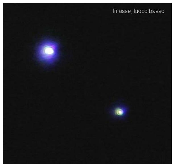
Fig. 2758 – Ai margini di un campo di 18 mm, appaiono i classici segni di un residuo di astigmatismo: la centrica è allungata quasi tangenzialmente. Poiché il centro del campo si trova esattamente in alto, fuori figura, si vede come le focaline astigmatiche non sono dirette del tutto tangenzialmente, ma un po' ruotate in senso antiorario. L'astigmatismo non è quindi del tutto simmetrico: qualche membro del sistema non è ben allineato.
