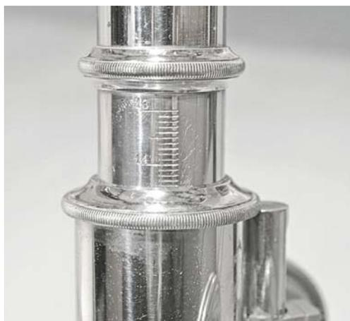
Fig. 2736 – Il tubo telescopico<sup>5</sup>, come sempre, prevede una parte più sottile, con la graduazione (70), che scorre all'interno di una boccia elastica (72) (vedi i tre tagli longitudinali) da cui non può uscire a causa dell'orlo sporgente di un anello avvitato al suo estremo inferiore (71).
