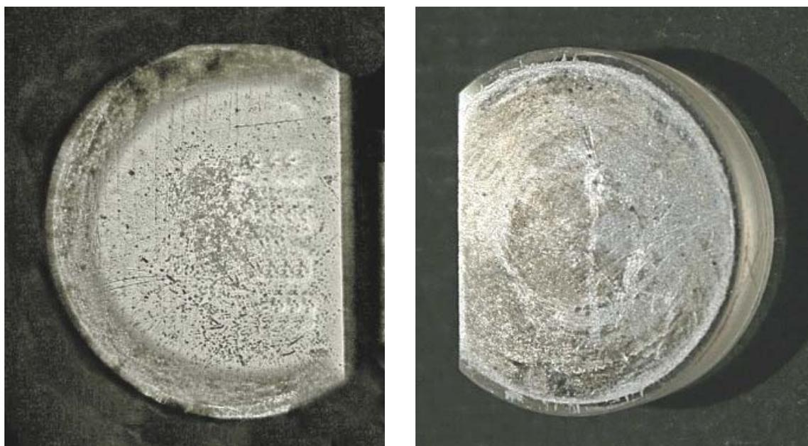
Fig. 2551/52 – Nessun tentativo di pulizia è efficace: si tratta proprio della corrosione della superficie del vetro.
