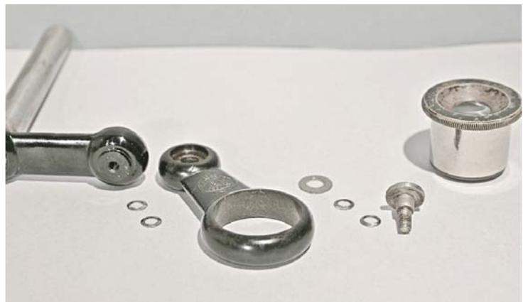
Fig. 2676 – Il braccio è fissato all'asta della messa a fuoco con un analogo meccanismo e lo stesso di tipo di vite.
