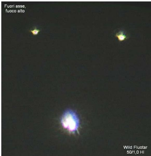
Fig. 2533 a/b/c – Ai margini di un campo di 18 mm, le centriche rivelano un residuo di coma, ma per il resto tutto sembra regolare.
