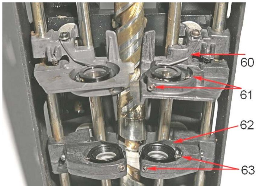
Fig. 2564 – Un dettaglio della fig. 2557. Qui si vedono meglio da sotto i grani di centratura (61 e 63) ed una delle molle (32) che spingono i pezzi mobili "Sup" ed "Inf" contro le barrette di guida 28 e 29.
