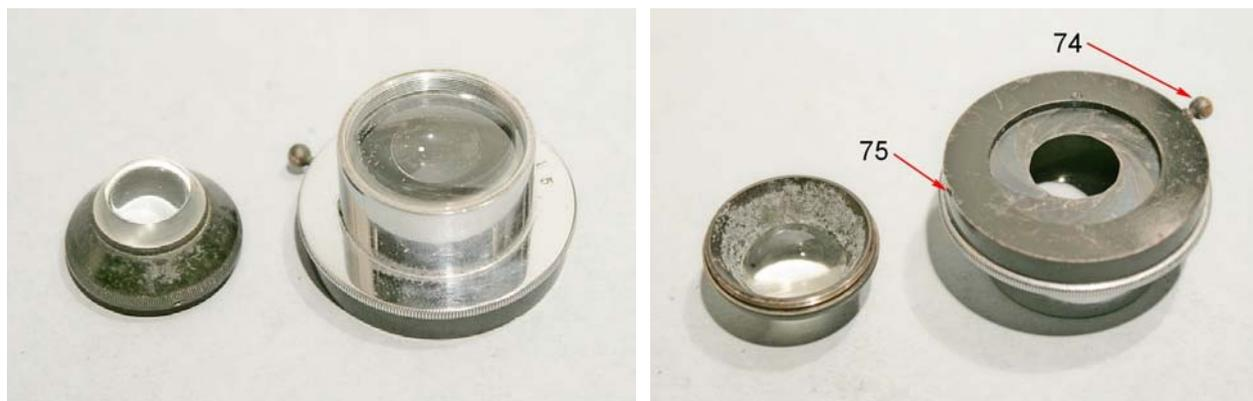
Figg. 2737/38 – Il condensatore smontato, visto da sopra e da sotto. La levetta 74 è, ovviamente, quella di comando del diaframma d'apertura. L'anello che porta le lamelle del diaframma è fissato alla base del condensatore da tre vitine, di cui solo una è visibile qui (75).
