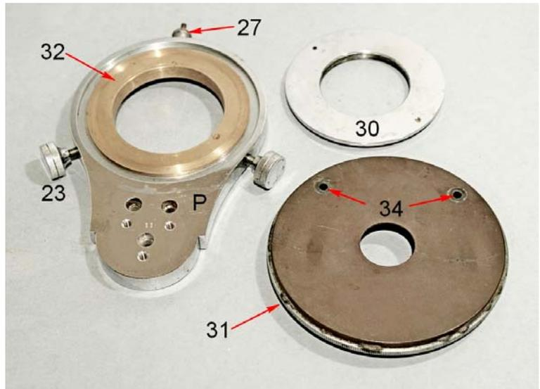
Fig. 2718 – Più da vicino, si vedono, sulla faccia inferiore dell’anello girevole 31, oltre l’orlo delle boccole 34 – con un taglio per poterle smontare da sotto con un cacciavite – anche la solita cifra “11” (freccia verde).
