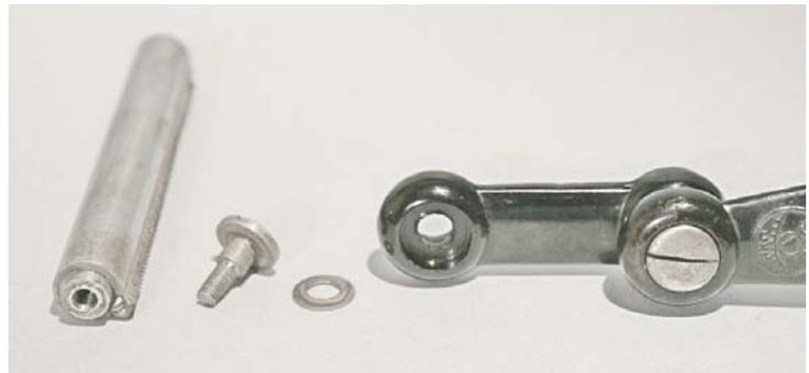
Fig.2677 – Il braccio e l'asta di messa a fuoco, come si possono estrarre dalla colonna semplicemente ruotando le manopole di messa a fuoco fino all'estremo superiore.
