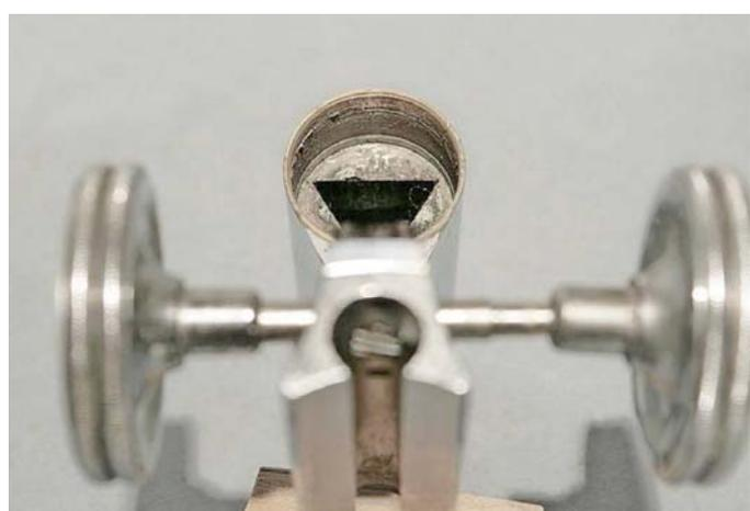
Figg. 2710/11 – Qui sopra si vedono le due estremità della colonna, in cui sono state ricavate due sedi per il prisma 15, già visto sopra. Anche sull'estremo inferiore della colonna è stata incisa la solita cifra 11.
