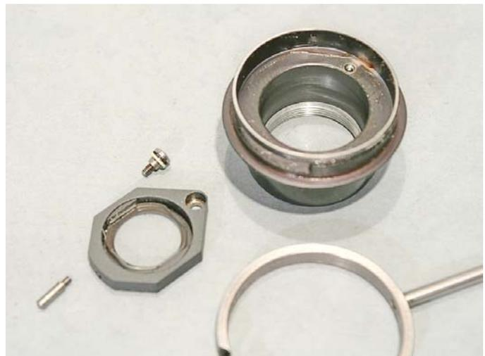
Fig. 2752/53 – L’anello 5 si smonta solo dopo aver tolto la vite 11, che attraversa una fessura nell’orlo superiore del corpo 6 dopo la finestra 5b nell’anello 5.
