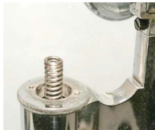
Fig. 2708 (a destra) – Sotto l'anello 11 appare una colonna prismatica triangolare (15) interna alla colonna cilindrica che porta il braccio 5.
