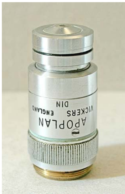
Fig. 2435 – Da fuori, tutto normale. Notare il sottile anello color celeste che, secondo un codice utilizzato modernamente da molti costruttori, indica l’ingrandimento del sistema, in questo caso, 50:1.
