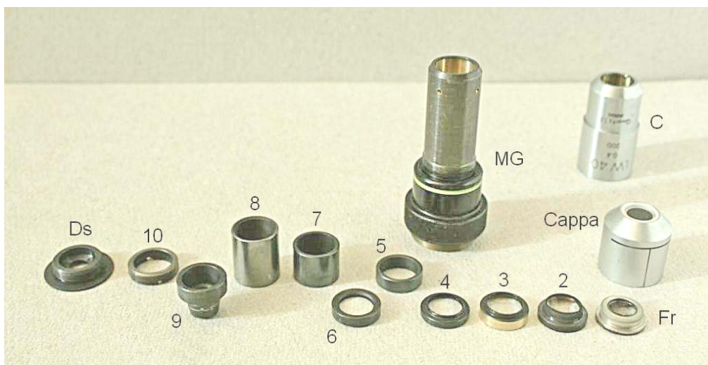
Fig. 2506 – Tolto l'anello 10, si sfilava verso l'alto tutto il pacco lenti composto da sei lenti (Fr, 2, 3, 4, 6 e 9) e da tre anelli distanziali (5, 7 ed 8). La lente 3 è quella flottante.
