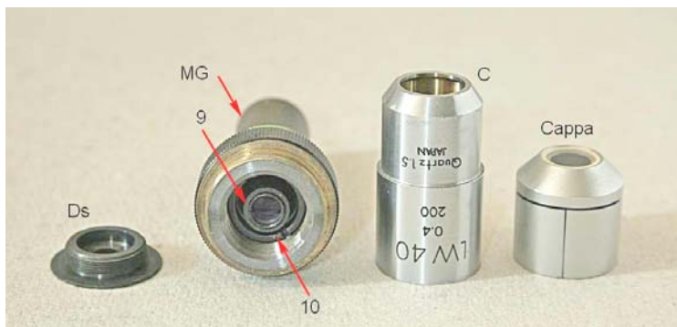
Fig. 2504 (sopra) – Tolta la cappa frontale, è facile svitare una camicia, quella che porta la notazione (al centro). Appare una lunga montatura generale, brunita, in cima alla quale affiora la lente frontale. Non esiste un barilotto generale né una montatura molleggiata.
