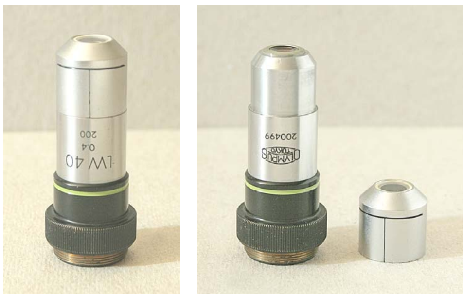
Fig. 2501/2502 – Da fuori, si nota subito la grande lunghezza di pareggiamento ( L_o = 60 mm) e la presenza di una cappa da infilare sulla lente frontale.
