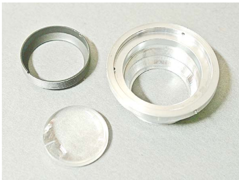
Fig. 2433 – Il cilindro 130, da sotto. Anche qui, un anello a due tacche fissa la lente inferiore; l'anello si può smontare senza difficoltà (a destra) a mezzo di un compasso.
