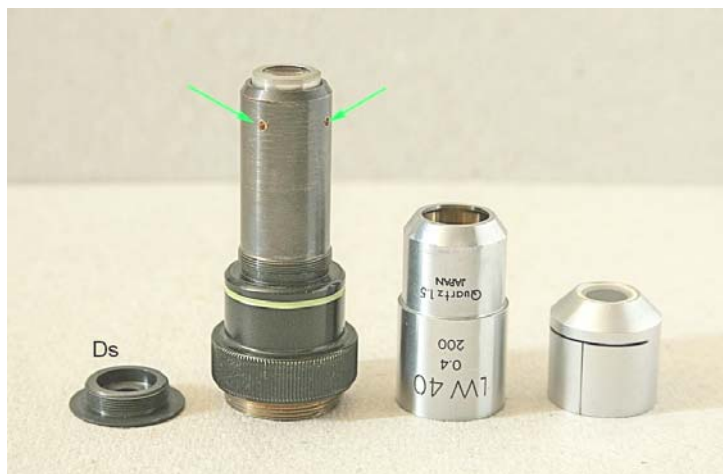
Fig. 2504 (sopra) – Tolta la cappa frontale, è facile svitare una camicia, quella che porta la notazione (al centro). Appare una lunga montatura generale, brunita, in cima alla quale affiora la lente frontale. Non esiste un barilotto generale né una montatura molleggiata.
