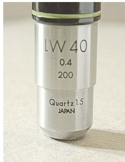
Fig. 2504 (sopra) – Tolta la cappa frontale, è facile svitare una camicia, quella che porta la notazione (al centro). Appare una lunga montatura generale, brunita, in cima alla quale affiora la lente frontale. Non esiste un barilotto generale né una montatura molleggiata.
