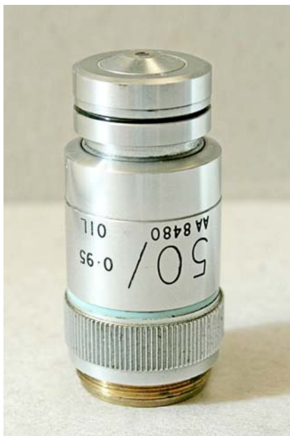
Fig. 2435 – Da fuori, tutto normale. Notare il sottile anello color celeste che, secondo un codice utilizzato modernamente da molti costruttori, indica l’ingrandimento del sistema, in questo caso, 50:1.
