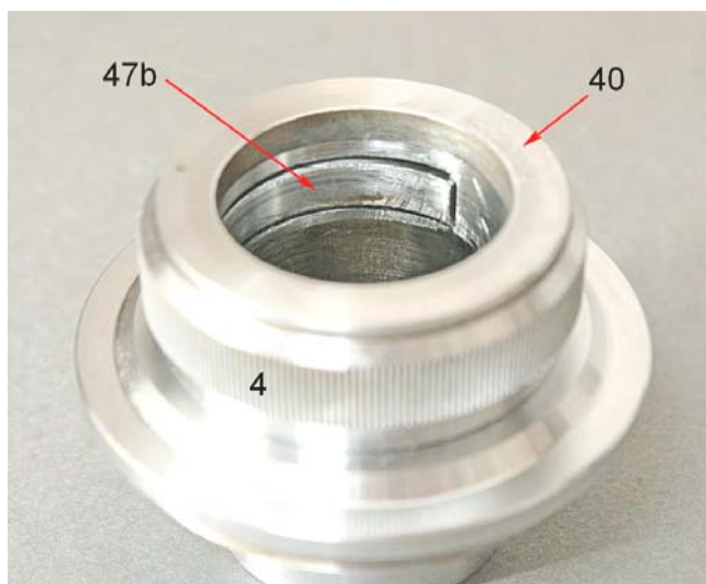
Fig. 2391 – Vista dall'interno, la linguetta elastica 47b.
