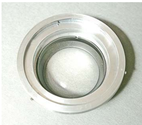
Fig. 2433 – Il cilindro 130, da sotto. Anche qui, un anello a due tacche fissa la lente inferiore; l'anello si può smontare senza difficoltà (a destra) a mezzo di un compasso.
