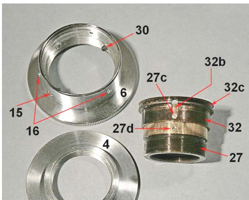
L'intervento sul blocco inferiore e sul diaframma di campo è stato necessario nel caso nostro per l'indurimento dei lubrificanti che avevano bloccato la rotazione dell'anello 4, e quindi la manovra del diaframma.
