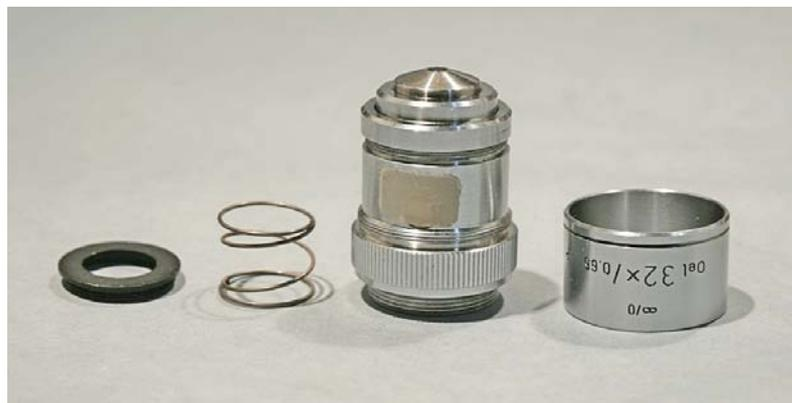
Fig. 2299 – Svitando l'anello A1 dalla montatura generale si può sfilare verso il basso il barilotto generale (BG). In questo si nota la scanalatura Sc in cui scorre il rivetto in plastica citato nella figura precedente. Inoltre, si vedono due corone di quattro fori ognuna (F), che potrebbero essere destinati alla centratura.
