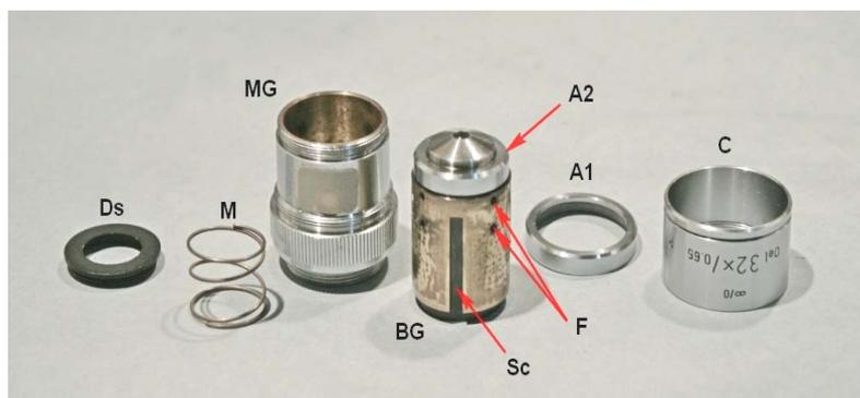
Fig. 2300 – Come si è detto, l'anello A2 si svita dalla cima del barilotto generale BG. Esso però è cementato (non avvitato) sul barilotto Fr che porta la lente frontale.
