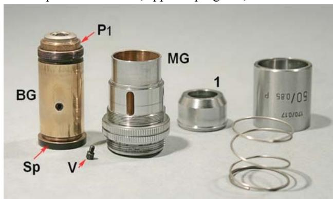
Fig. 2283 (a sinistra) – Dopo tolta la vite V, il barilotto generale (BG) si sfilare dall’alto. Verso il basso, esso è impedito dalla spalla Sp, che sporge da un tubetto a vite avvitato in cima al barilotto (foto seguente) (“alto” e “basso” rispetto alla posizione di lavoro).
