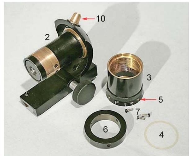
Fig. 2371 – Da un lato del cilindro 2 appare una finestra nella quale scorre un tratto di cremagliera (1) destinato ad ingranare nel filetto interno del tubo 3. Il gioco denunciato nella regolazione dello zoom, cioè nella rotazione del tubo 3, dipende proprio dal gioco fra le parti 1 e 3.
