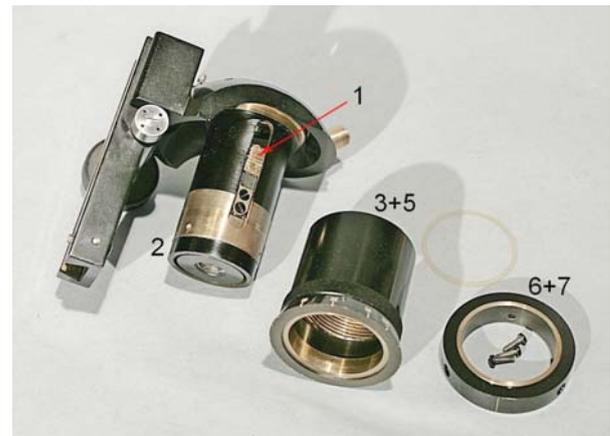
Fig. 2372 – Il pezzo dentato 1 è fissato alla laminetta 70 da due rivetti e quella è fissata al tubo interno scorrevole dello zoom da un piastrino in ottone (71) fissato a sua volta dalle due viti 72. La laminetta 70 servirebbe a garantire un appoggio costante del pezzo 1 alla filettatura del tubo 3, ma nel nostro caso le due parti erano separate da un piccolo spazio, che causava il gioco riscontrato.
