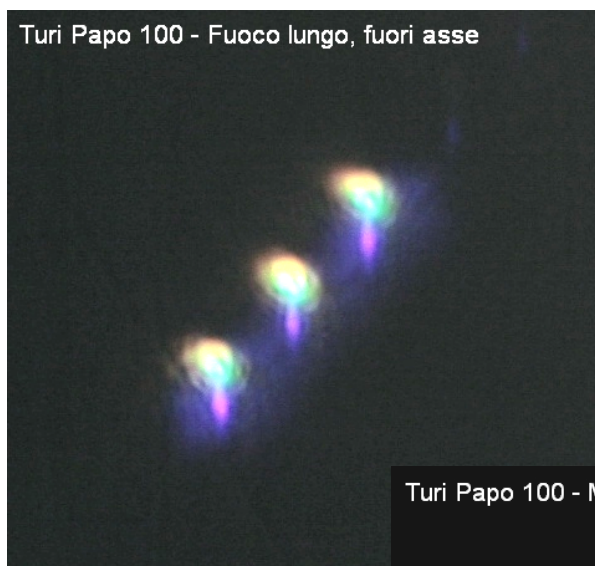
Fig. 2187 a/b/c – Ai margini di un campo immagine di 20 mm sono evidenti piccoli residui di coma simmetrica e di cromatica laterale sovracorrecta. Ma per quest'ultima abbiamo già notato che l'oculare usato è sovra-compensato.
