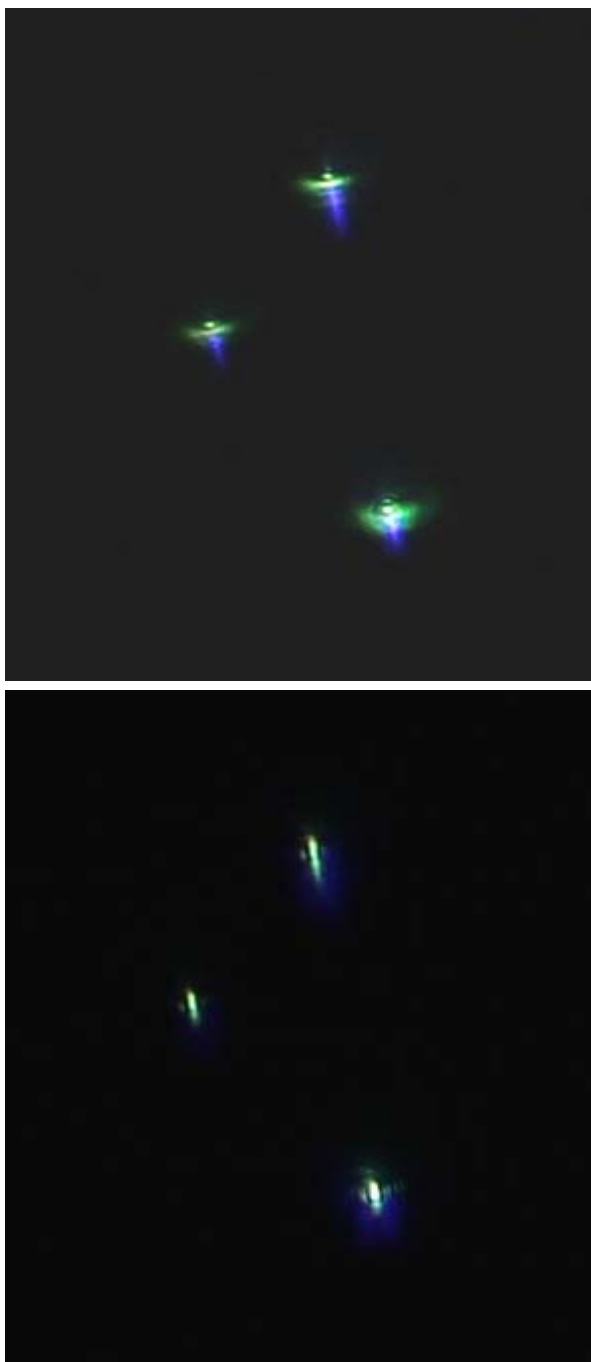
Fig. 2257 a/b/c – Nessuna sorpresa. Le focaline sono dirette quasi tangenzialmente (in alto) e quasi radialmente (in basso), sopra e sotto il miglior fuoco.
