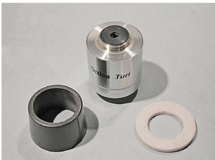
Fig. 2181 a/b – Idea: realizzare con apposite fustelle un anello di feltro di almeno 2 mm di spessore, di diametro tale da coprire la giuntura in questione.
