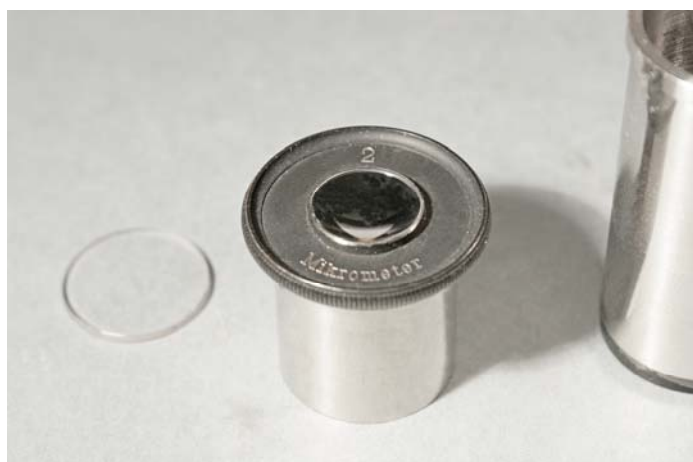
Fig. 2173 – La parte superiore, mobile, con la notazione dorata su fondo nero. A destra, il reticolo.
