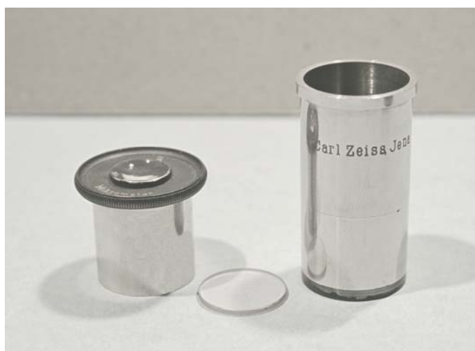
Fig. 2172 – Visione esterna dell'oculare, intero e con le due parti separate.
