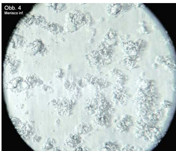
Fig. 2249 a/b (sopra) e c (sotto) – Con illuminazione a “fessura decentrata” (vedi, in questo sito, sez. Microscopia ottica, l’art. n° 41), spostando il solco nello star test, cioè la fessura, si osserva comunque un brutto quadro. Esaminando sotto lo stereoscopico i vari membri (sotto a destra), risulta essere alterata la superficie concava del menisco inferiore.
