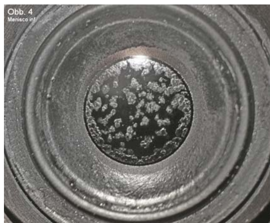
Fig. 2249 a/b (sopra) e c (sotto) – Con illuminazione a “fessura decentrata” (vedi, in questo sito, sez. Microscopia ottica, l’art. n° 41), spostando il solco nello star test, cioè la fessura, si osserva comunque un brutto quadro. Esaminando sotto lo stereoscopico i vari membri (sotto a destra), risulta essere alterata la superficie concava del menisco inferiore.
