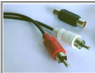
Figura 7 - Connettori Video Composito (RCA) per segnale analogico. Possono essere usati anche per collegamenti audio.
