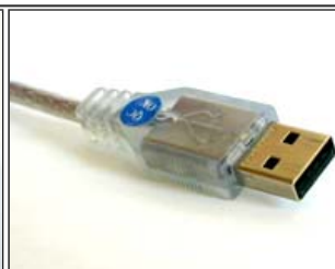
Figura 9 - Connettore USB per segnale digitale.
