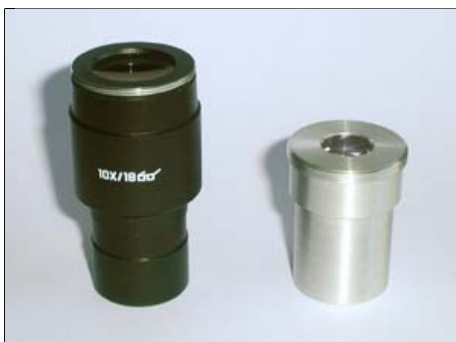
Figura 5 - Oculari per fotografia. Notate la filettatura di cui sono dotati.
