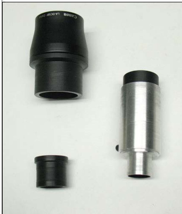
Figura 2 - Dall'alto in senso orario: adattatore per macchina fotografica, oculare a pupilla alta, adattatore per sedi da 30,5 mm di diametro.
