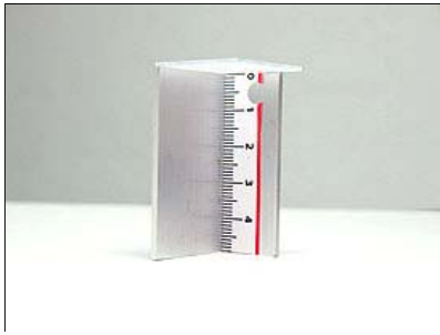
Figura 3 - Piccolo attrezzo per misurare l'altezza della pupilla.
