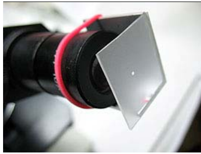
Figura 4 - L'attrezzo è sistemato su di un oculare e ne mostra la pupilla a fuoco.
