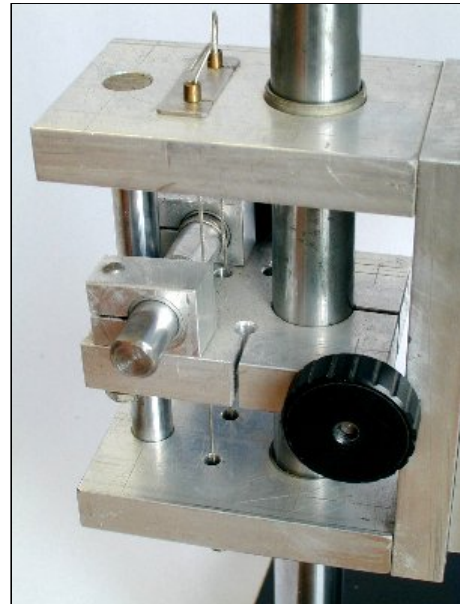
Figura 8 - Dispositivo di messa a fuoco (una manopola è stata rimossa). Notate la struttura a "C" del carrello, i cavi, l'alberino di manovra, le viti che fermano i supporti e che manovra, i supporti. Il foro sulla piastra intermedia per il passaggio della colonnetta è reso elastico per mezzo dell'intaglio anteriore e di altri due intagli laterali. Stringendo la manopolina, la piastra si fissa sulla colonnetta.
