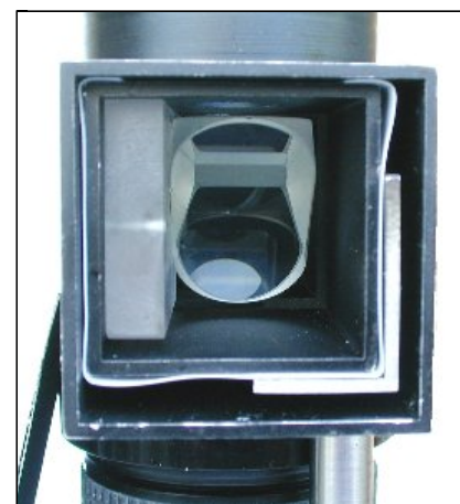
Figura 13 - Scatola dei prismi, vista interna da sinistra (il tappo è stato rimosso). Notate il prisma, la piastrina, la slitta, il foglio di teflon, il profilato ad "L", il tubo esterno. Il foglio di teflon avvolge quasi interamente la slitta.
