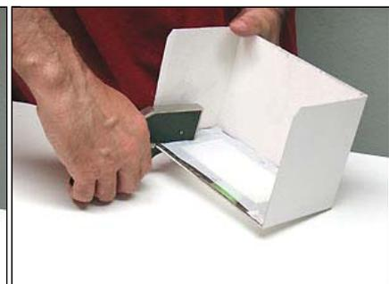
Figura 10 - Fissaggio dello schermo.
