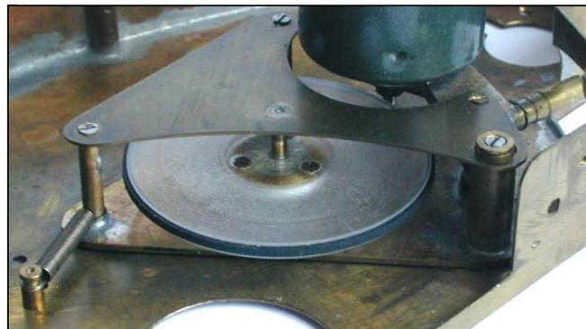
Figura 29 - Puleggia intermedia. Osservate sulla sinistra la molla di tiro contro la puleggia principale (rimossa). Si intravede l'albero del motorino contro la puleggia intermedia.
