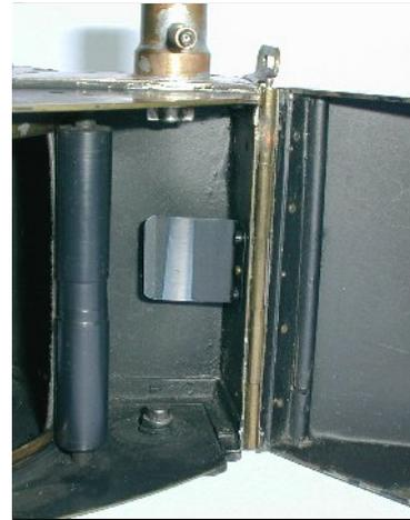
Figura 22 - Alloggiamento per il rocchetto su cui si avvolge la pellicola. Notate la colonnetta rotante in PVC, la lamina piana che appoggia sulla colonnetta e che determina il bordo dell'immagine. La lamina metallica piccola serve a facilitare l'estrazione del rullo esposto. Notate infine in basso la lamierina piegata che corre tra la piastra inferiore e la lamiera anteriore.
