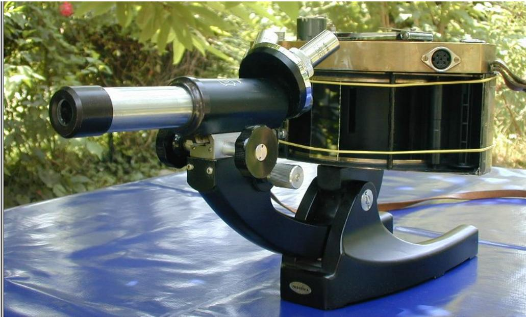
Figura 34 - Come usare un microscopio per regolare la posizione dell'obiettivo. Note il vetrino fermato sulle guide da due elastici.
