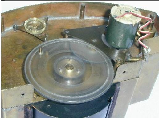
Figura 28 - Dispositivo per la rotazione del tamburo. Si noti la puleggia principale, la puleggia intermedia e il motorino elettrico. Più indietro è visibile la bolla montata su viti calanti. Il frontale è stato tolto per mostrare meglio la puleggia principale ed il tamburo.
