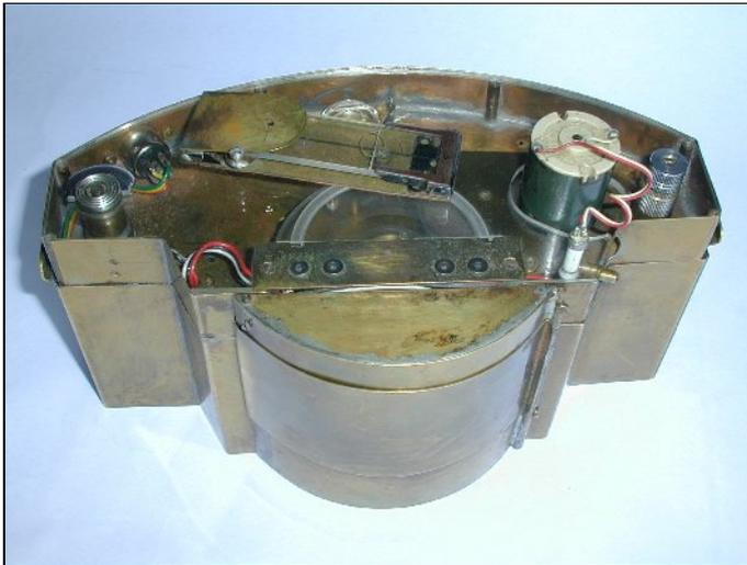
Figura 24 - Vano per il dispositivo di rotazione del tamburo. Esso è chiuso da un coperchio trasparente. Oltre al dispositivo di rotazione, vi sono i cavi e la bolla. Sopra è visibile il mirino ripiegato e le manopoline di manovra.
