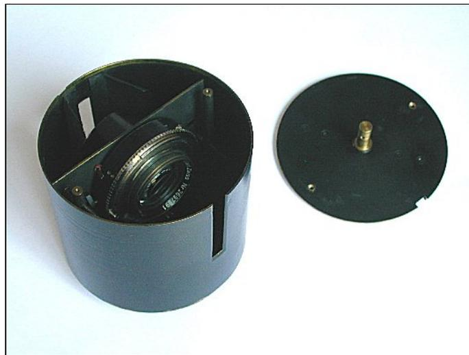
Figura 11 - Tamburo rotante. Il tappo superiore è stato tolto per mostrare l'obiettivo ed il dispositivo di centraggio.
