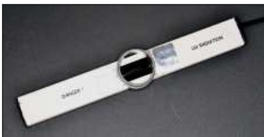
Fig. 23: Il dispositivo di illuminazione per microscopia a UV (Luce di Wood) in diascopea.
