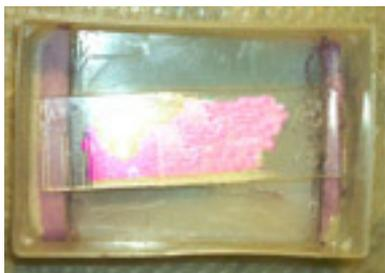
fig. 63. Un portaoggetti poggiato su due supporti all'interno della vaschetta; lo striscio è posto sulla faccia inferiore del vetrino che affaccia verso il fondo. Il colorante verrà versato nella vaschetta fino a ricoprire totalmente il vetrino: in tal modo si eviteranno depositi.
