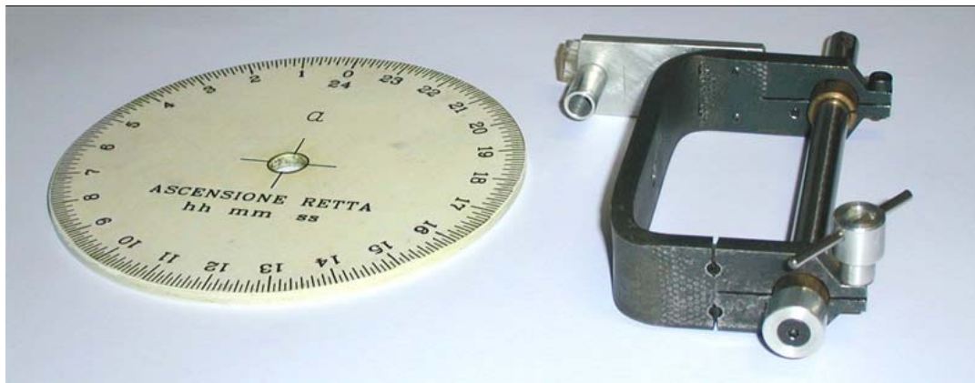
Figura 12 - Disco dell'Ascensione Retta e forcilla. Notate sulla forcilla gli intagli laterali per rendere più flessibile il morsetto inferiore.
