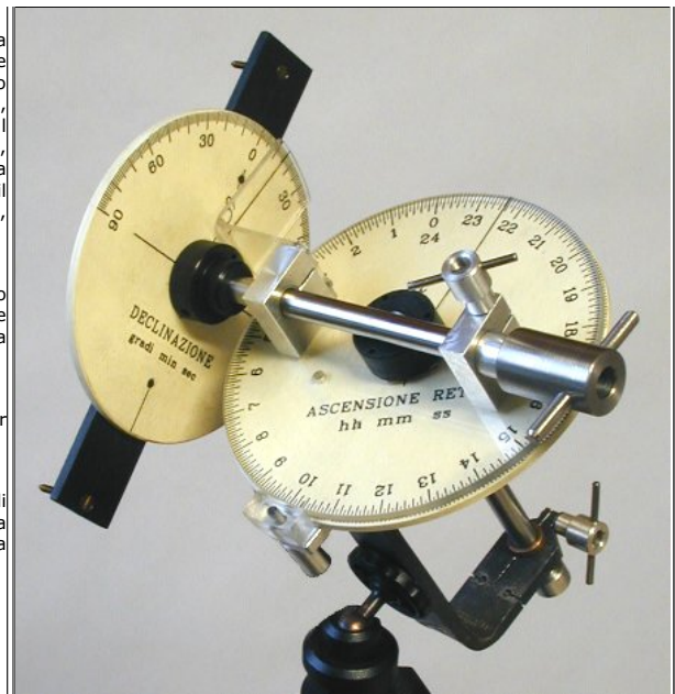
Figura 14 - Secondo indicatore siderale. Questa immagine mostra alcune modifiche allo strumento rispetto alle figure 9, 10 e 11. In particolare, è stato inserito il freno della Declinazione (sul supporto destro), mentre l'indice della Declinazione (sul supporto sinistro) è stato realizzato con una piastrina di plexiglas piegata a 90°.
