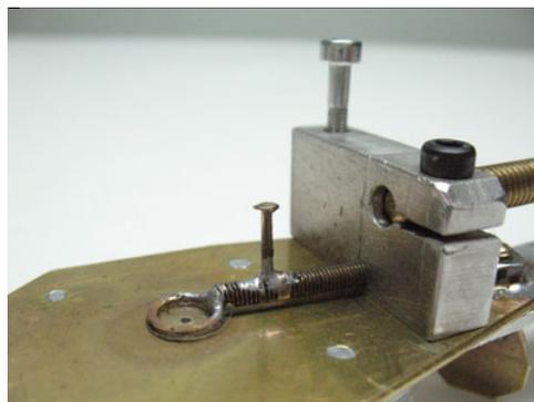
Figura 5 - Punta ad occhio per campioni liquidi. Notate anche il foro sul blocchetto all'estremità della vite principale reso elastico con un intaglio di sega.
