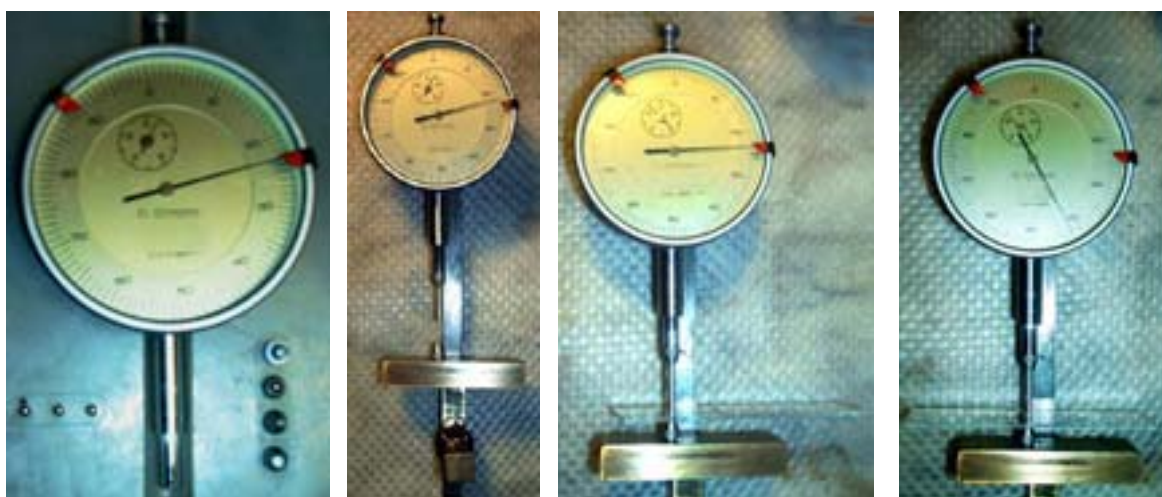
Fig. 7 : (Da sinistra) (a) Un comparatore micrometrico nella sua confezione; (b) il comparatore montato sul supporto di misura; (c) mentre misura lo spessore del portaoggetti; (d) mentre misura lo spessore del coprioggetti montato.
