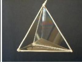
Figura 17 - Lamine in un telaio piramidale (tetraedro). Depositata una bolla al centro.
