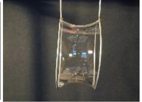
Figura 19 - Lamina tuboidale fra due anelli, ottenuta rompendo la lamina in comune.
