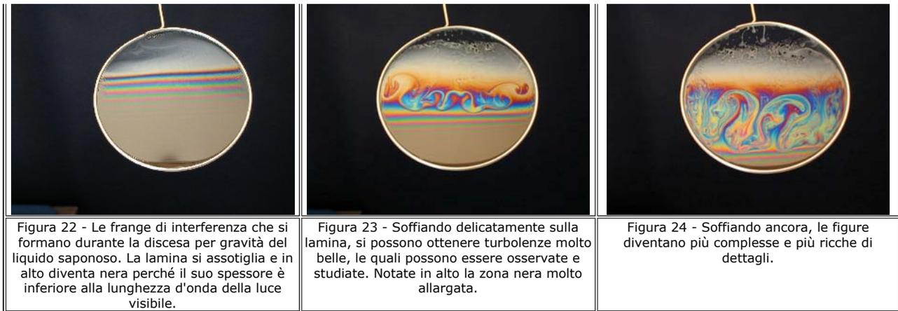
Figura 22 - Le frange di interferenza che si formano durante la discesa per gravità del liquido saponoso. La lamina si assottiglia e in alto diventa nera perché il suo spessore è inferiore alla lunghezza d'onda della luce visibile.
