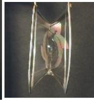
Figura 18 - Lamine fra due anelli unite da una lamina in comune.
