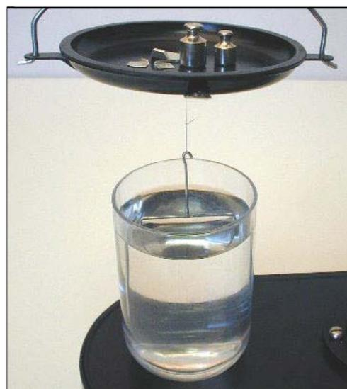
Figura 6 - Telaietto ad "U" nel liquido in esame.
