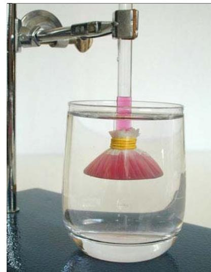
Figura 25 - Dispositivo per la dimostrazione dell'osmosi.
