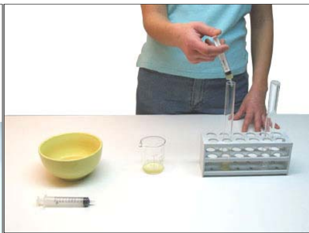
Figura 9 - In una provetta, inserite 5 cc di filtrato e 1 cc di succo di ananas.
