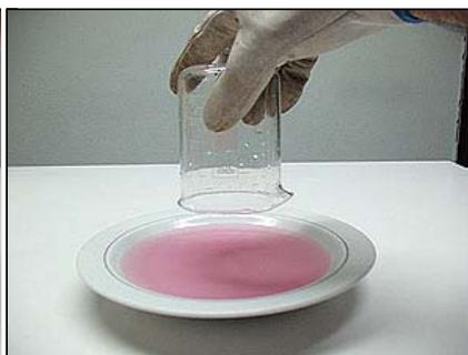
Figura 6 - Tenete il Becker capovolto per scaldare l'aria al suo interno.
