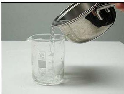
Figura 5 - Versate acqua bollente nel Becker per scaldarlo.
