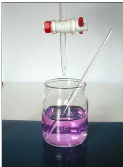
Figura 20 - Interrompete il gocciolamento appena il liquido nel becker cambia colore.
