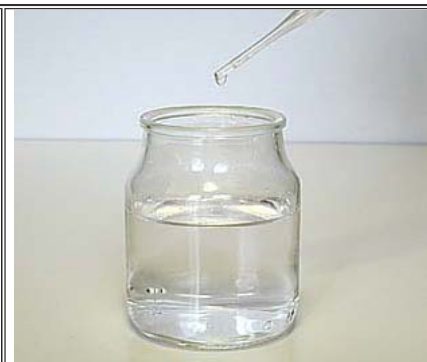
Figura 16 - Aggiungete 3 gocce di fenolftaleina a 100 ml d'acqua. Otterrete una soluzione incolore.
