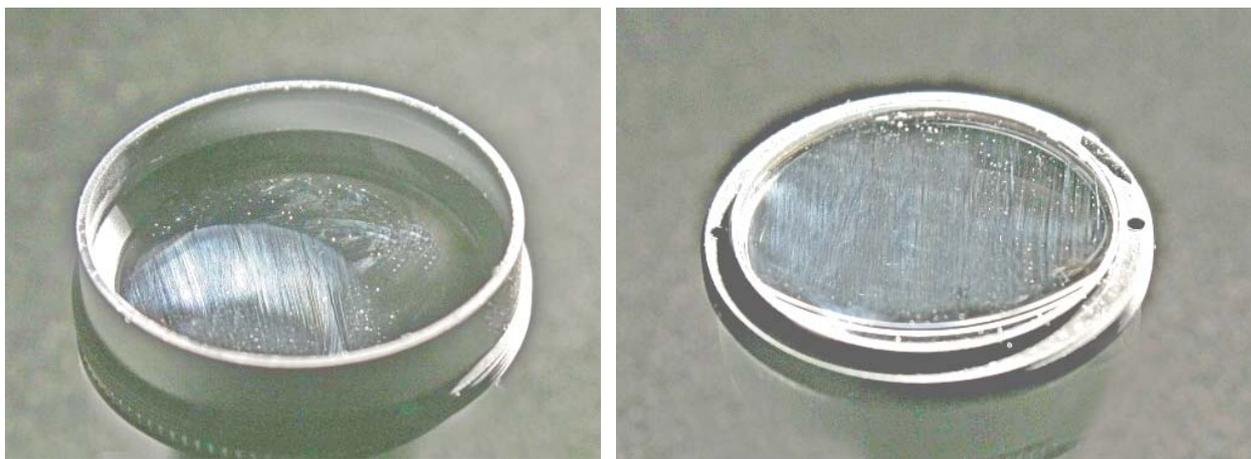
Fig. 18 a/b – L'andamento striato di queste pàtine fa subito pensare allo sfregamento di un tampone su una superficie poco pulita.
