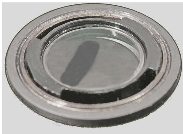
Fig. 15 – Una lente simile a quella delle figure precedenti può quasi funzionare da anemometro, purché non si abbia fretta ... La velatura segue una direzione preferenziale.
