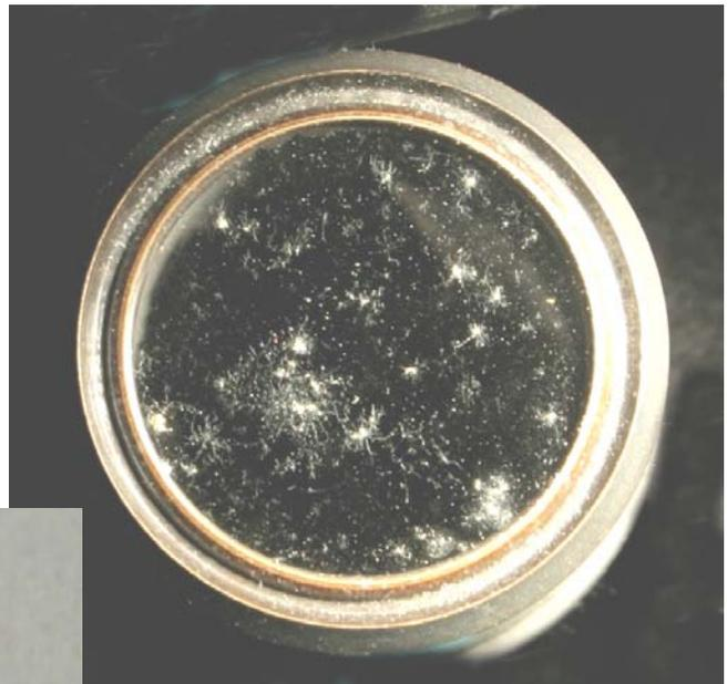
Fig. 9 – Superficie del prisma della figura precedente. A forte ingrandimento, si vede la traccia delle singole ife. Attorno ad esse, si vedono però piccoli punti di corrosione dovuti a sostanze diffuse dalle ife.
