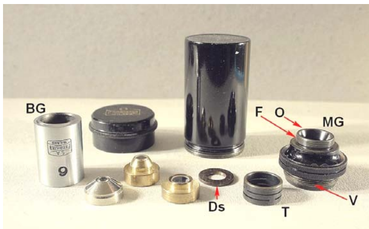
Fig. 8 – La montatura generale (MG) mostra la vite di fissaggio (V) e, dall'altra parte, un sottile filetto (F). Su questo si avvitano un barilotto generale (BG), filettato all'interno da un lato e terminante dall'altro con un orlo rientrante (vedi in alto, presso la scritta BG).
