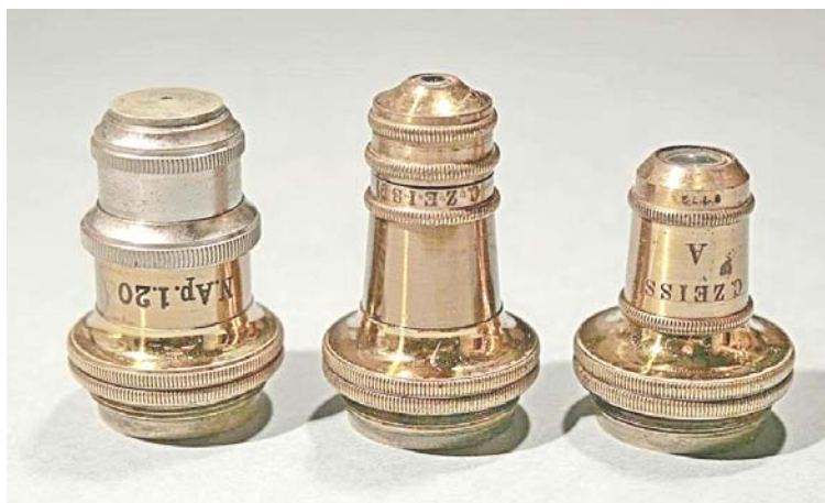
Fig. 6 – Una serie di obiettivi della casa C. Zeiss, del 1892 circa, sempre con barilotti avvitati l'uno sull'altro.
