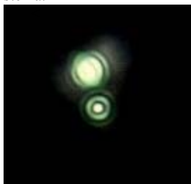
Fig. 10 a/b – Una centrica ideale in condizioni di miglior fuoco, in rappresentazione assonometrica (a destra) e come appare nel caso di un obiettivo di medio ingrandimento (a sinistra).
