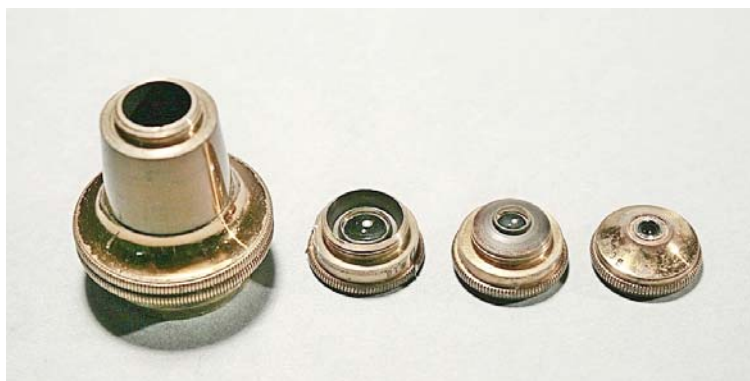
Fig. 7 – L'obiettivo centrale della serie precedente, smontato nei suoi componenti: tre barilotti avvitati l'uno sull'altro e l'ultimo sulla montatura generale.
